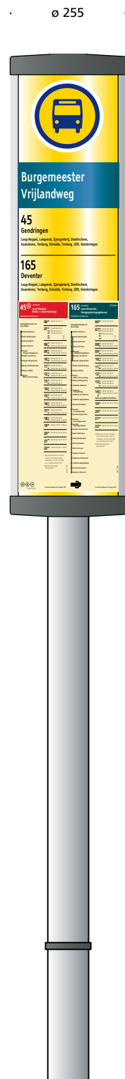
De basisvorm van deze informatiezuil bestaat uit twee ronde kokers die om een paal bevestigd zijn met afsluitdoppen.
